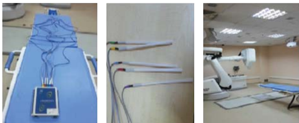
Resim 3. Mosfet lineer dozimetri sistemi
