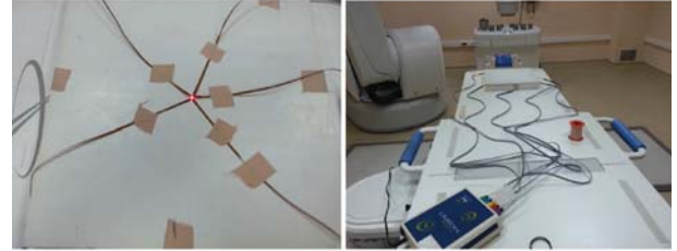
Resim 4. Mosfet dozimetri sisteminin kalibrasyon faktörünün belirlenmesi işlemi
