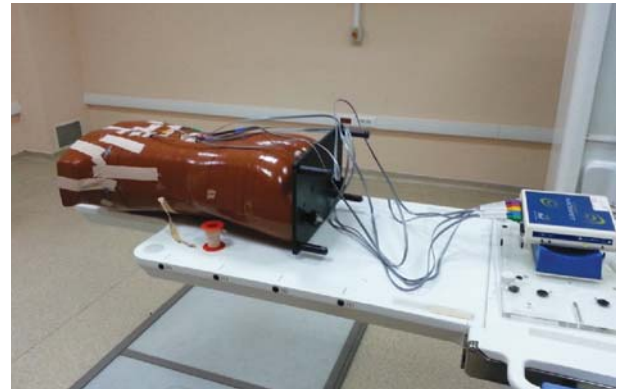
Resim 5: Mosfet dozimetri sisteminin rando fantomun içerisine yerleştirilmesi
